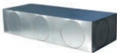
I plenum sono composti da una lamiera elettrozincata in fogli di alluminio, con uno strato di isolante di 10mm, e dotati di prefori da 150 o 200 mm. Collarini e componenti per il montaggio sono inclusi.
