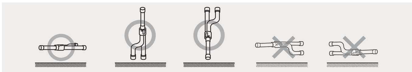
Il collettore deve sempre avere una posizione orizzontale con le uscite dal corpo frontali oppure, in alternativa, con le uscite verticali verso il basso tagliando la "L" del collettore del liquido.
