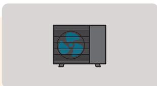
Unità esterna monoblocco a bassa rumorosità Aria-Acqua collegata mediante tubazioni idriche all'impianto.
