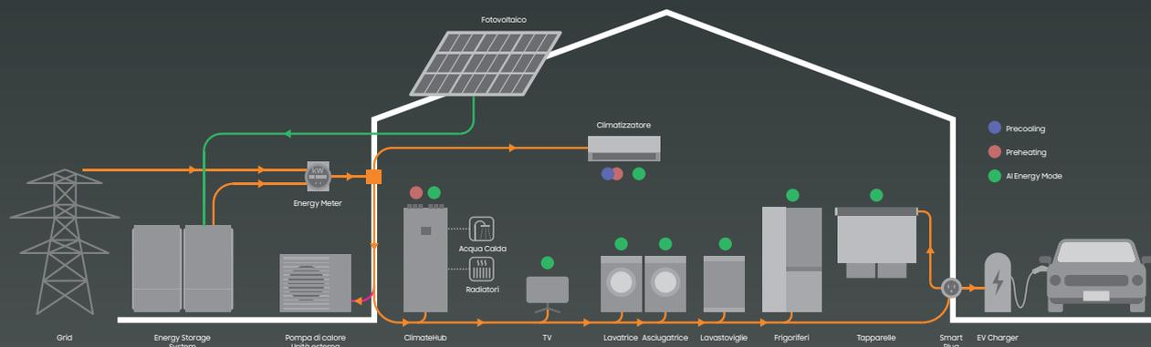
Ad esempio, SmartThings Energy può gestire un surplus di produzione energetica dell'impianto fotovoltaico andando a pre-riscaldare l'acqua del ClimateHub. In caso contrario, se c'è un deficit di energia, SmartThings può ridurre il consumo dei dispositivi Samsung utilizzando la funzione AI Energy.
