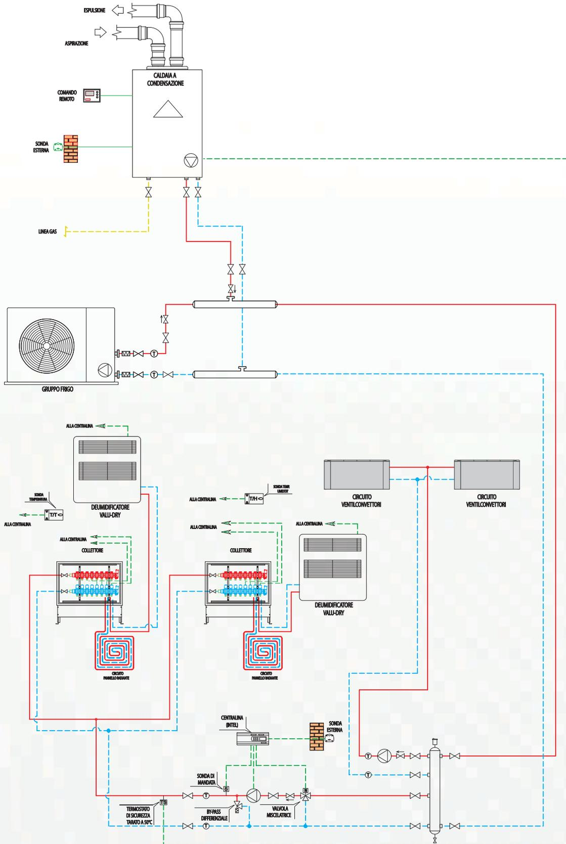
**SCHEMA TIPO PER IMPIANTO DI RISCALDAMENTO E RAFFRESCAMENTO VALU-TECHNIK
