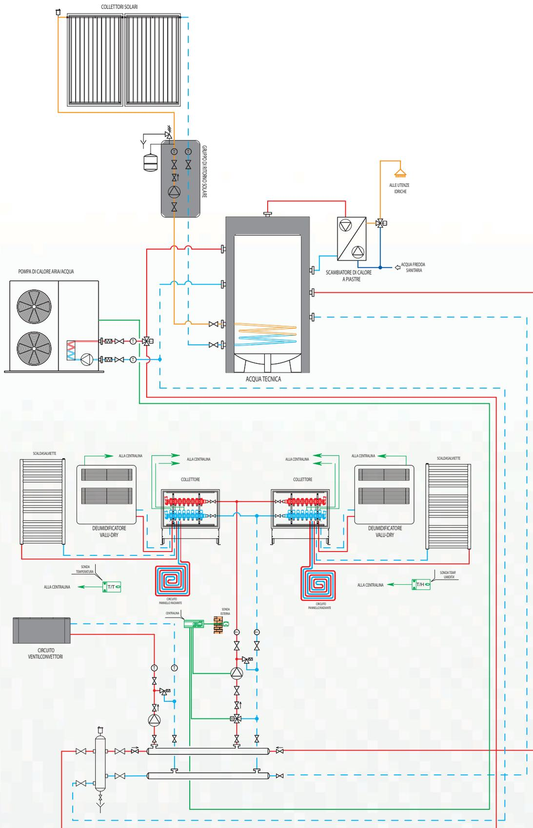
**SCHEMA TIPO PER IMPIANTO DI RISCALDAMENTO E RAFFRESCAMENTO VALU-TECHNIK
