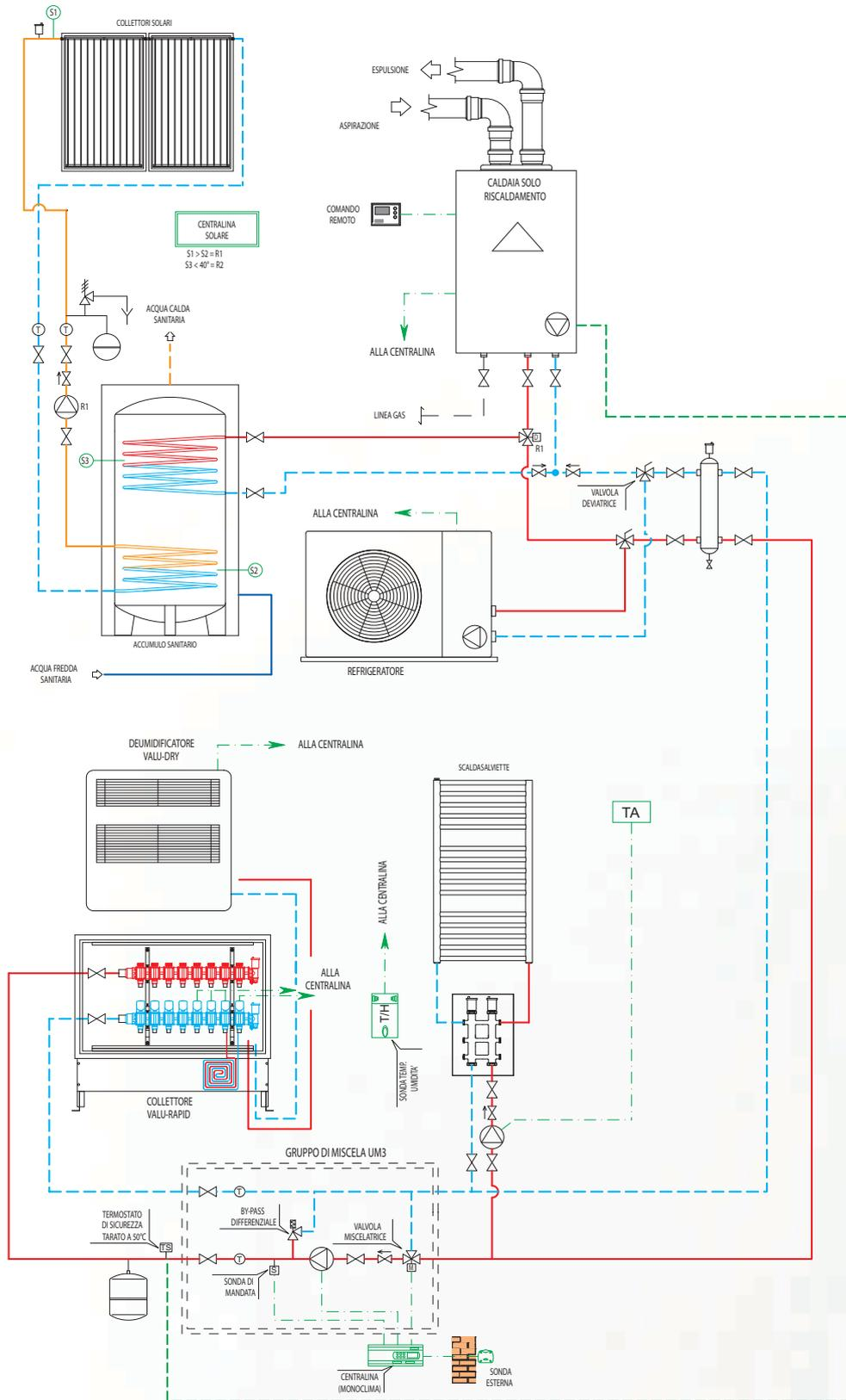
NOTA: REGOLAZIONE DELLA TEMPERATURA DI MANDATA MEDIANTE GRUPPO DI MISCELA UM3 CON REGOLATORE CLIMATICO E CENTRALINA COMPLETA DI SONDA ESTERNA
