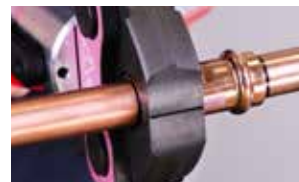
10. Completare la giunzione utilizzando unicamente utensili omologati. Pressare una sola volta
