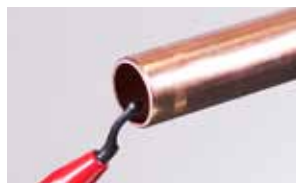
3. Utilizzare uno sbavatore a stilo sui bordi del tubo interno
