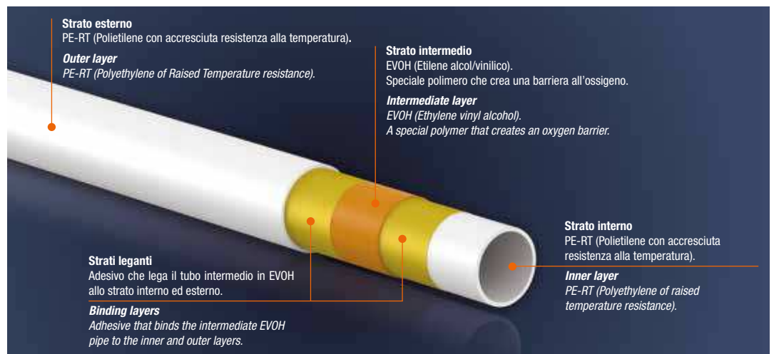
Stratigrafia tubo polipert Polipert pipe stratigraphy
